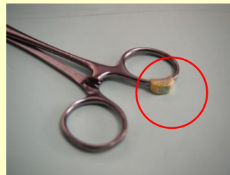
鋼製小物用樹脂製UHF帯RFIDタグ（試作）
